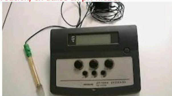
La mesure est fiable pour des pH variant entre 1 et 13, soit pour des concentrations en ions  $\text{H}_3\text{O}^+$  variant entre  $10^{-1}$  et  $10^{-13} \text{ mol} \cdot \text{L}^{-1}$ . L'incertitude sur la mesure est alors de 0,1 unité.
