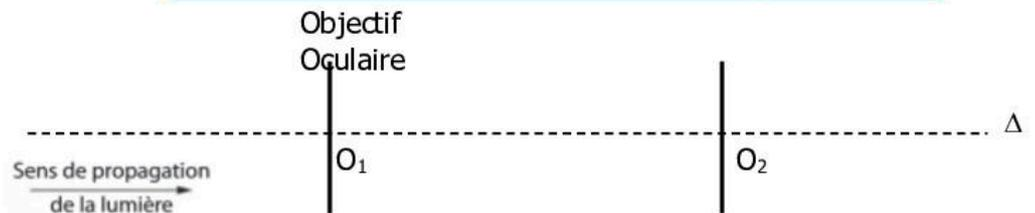
Le **foyer image  $F'_1$**  de l'objectif est confondu avec le **foyer objet  $F_2$**  de l'oculaire, d'où le nom **Lunette afocale** (pas de foyer).
